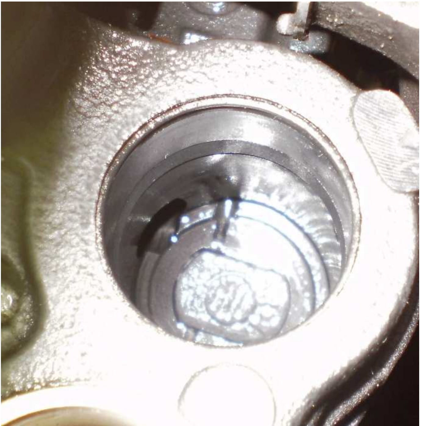
Pohled na těsnicí kroužek a prachovku dovnitř těmenu
