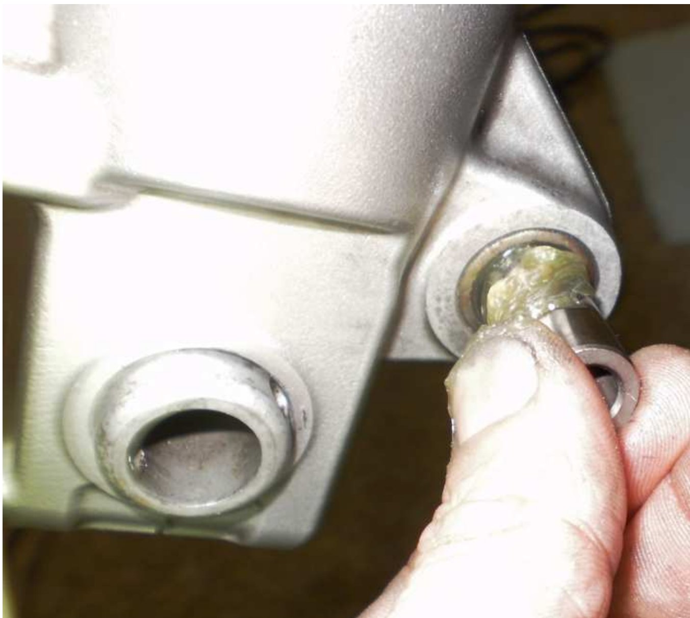
Vložka zasunuta do klece ložiska
