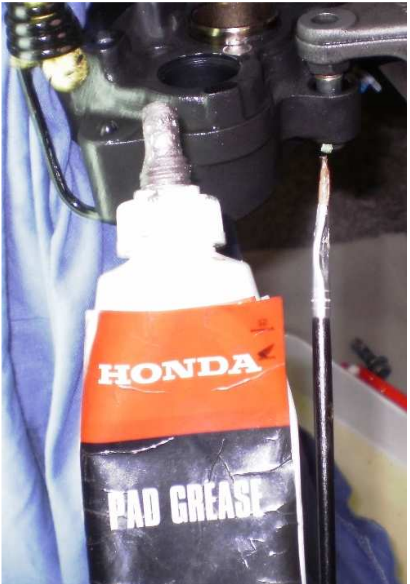
Měděná vysokoteplotní vazelína pro brzdy a jejich komponenty
