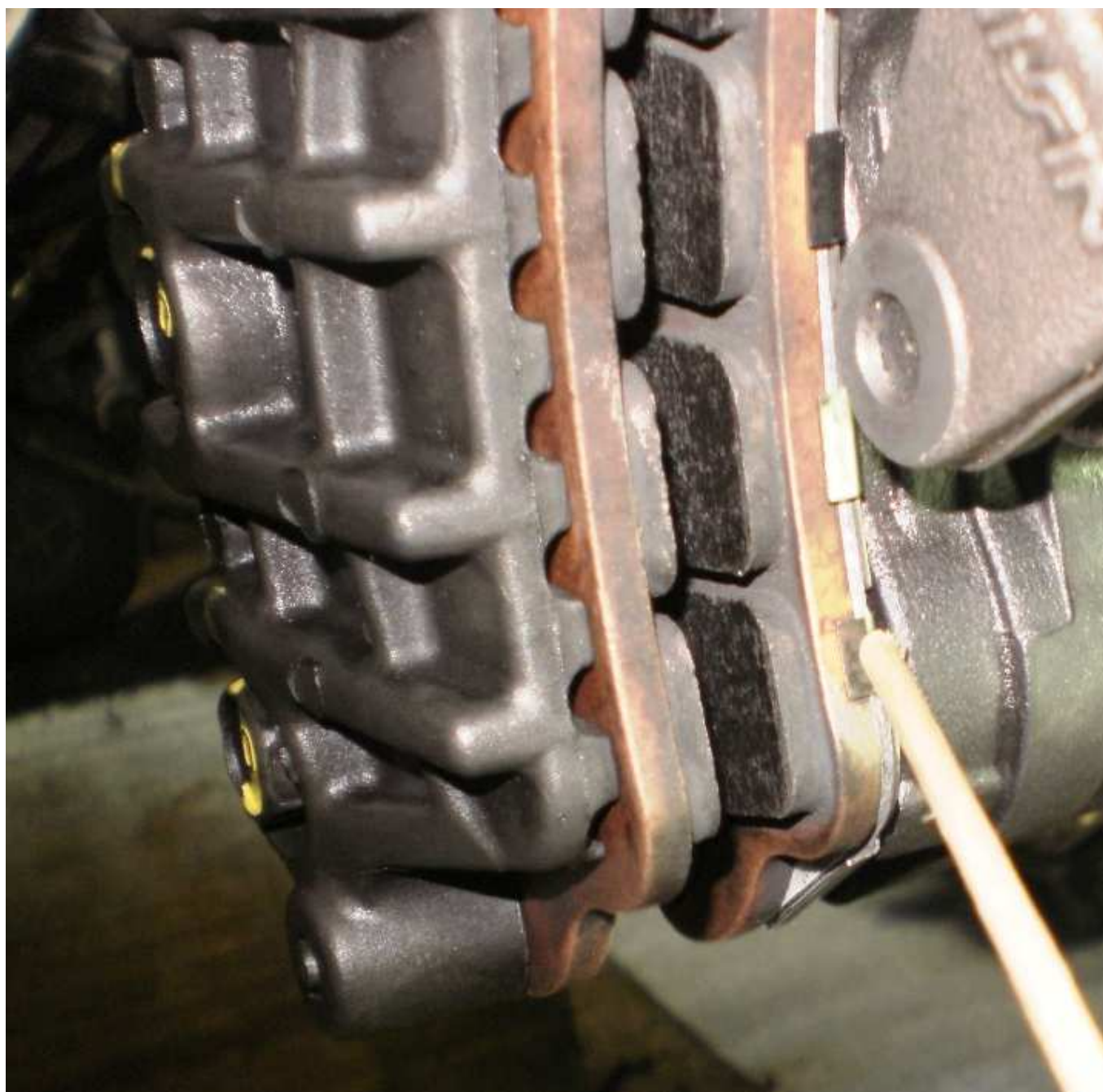
Velký stínící plech s odstiňujícím plastem ze zadního kola na straně pístků u levého předního třmenu.
