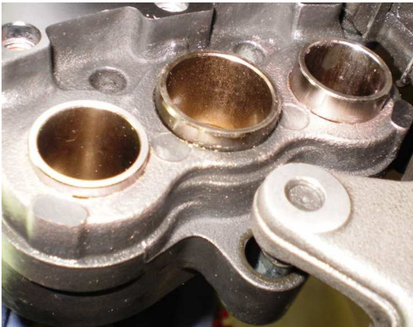
Pístky zasunuty a povrch otřen od přebytečné vazelíny
