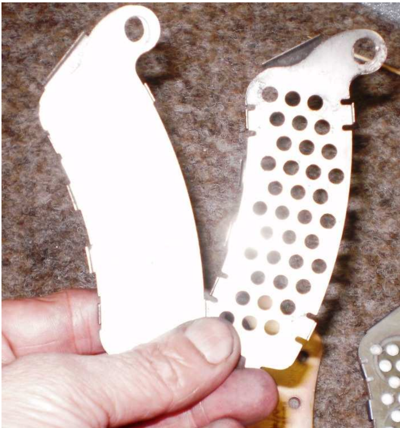
Vlevo stínící plech ze zadních destiček....., vpravo z předních
