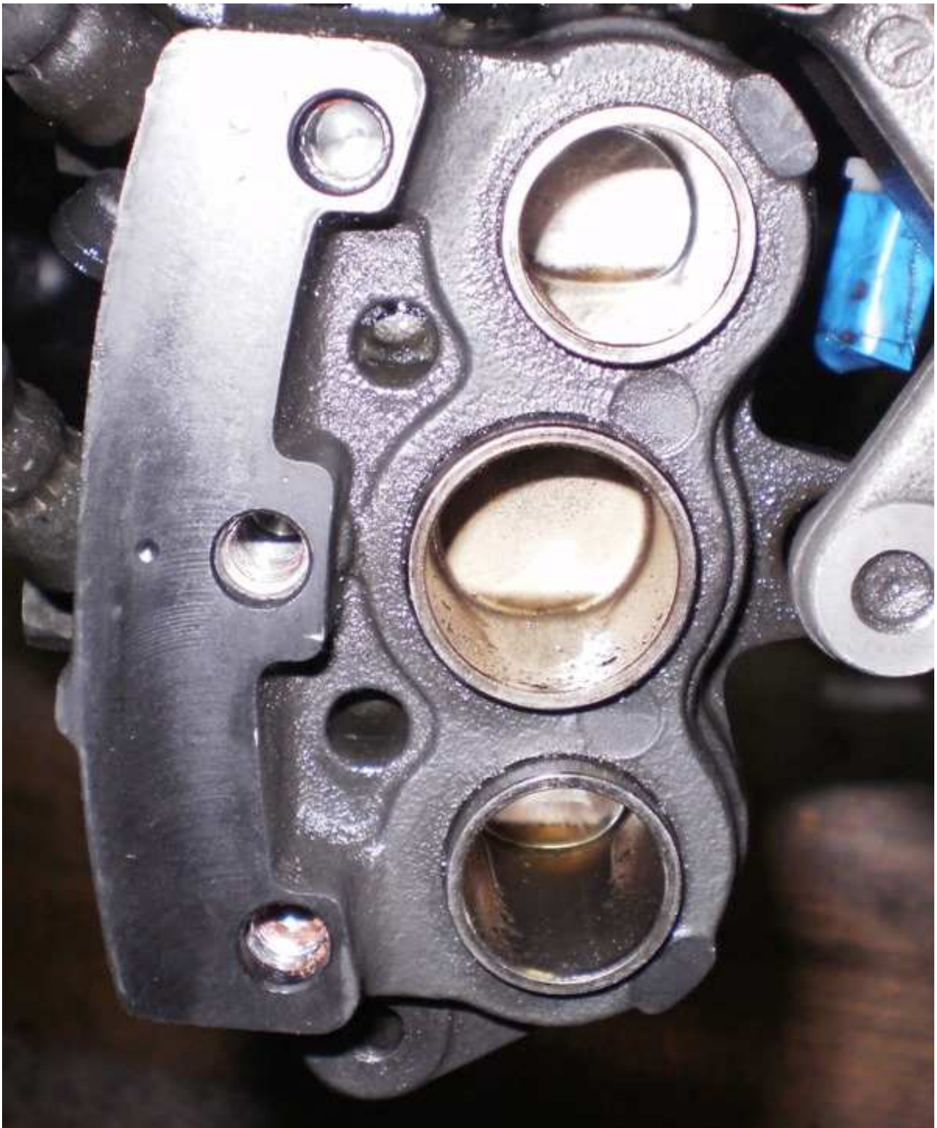
Vyčištěný vnitřek třmenu.... WD a silikonový olej.
