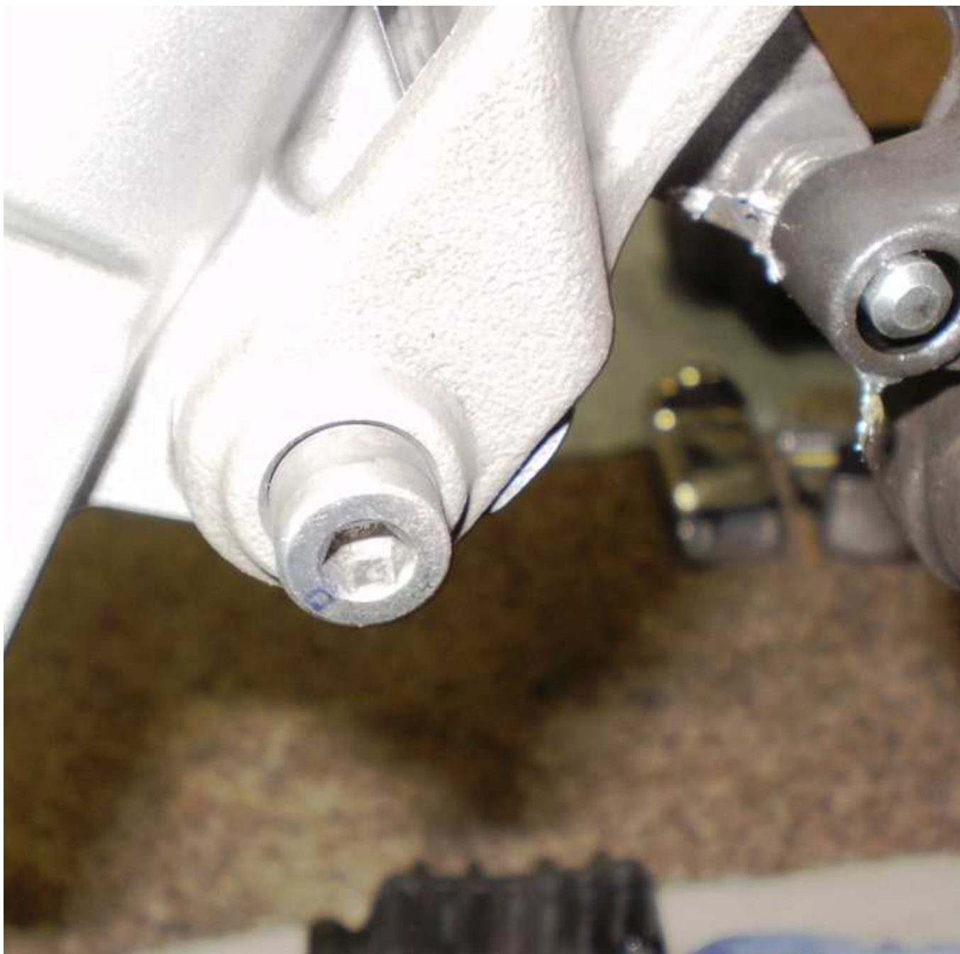
Dolní otočný čep na levém třmenu – dotahovací moment 31Nm +Loctite
