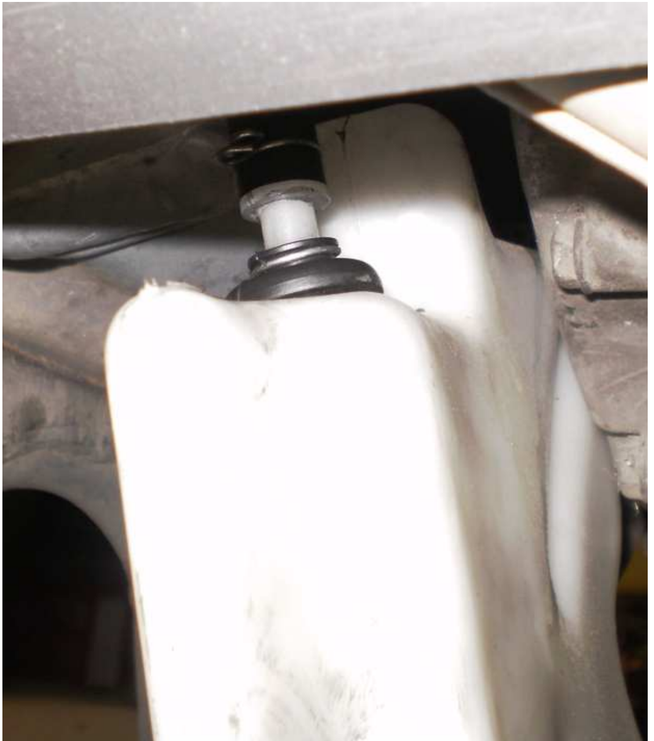
Nasazeny a pojištěny obě hadice zpět v expanzce
