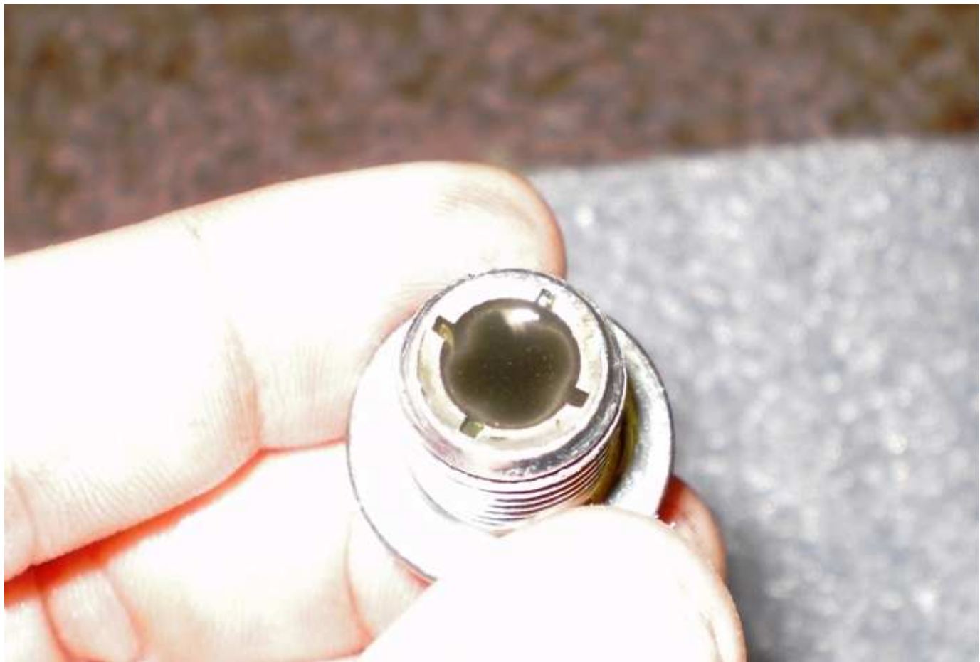
Magnetická vypouštěcí zátka s kovovými nečistotami uvnitř
