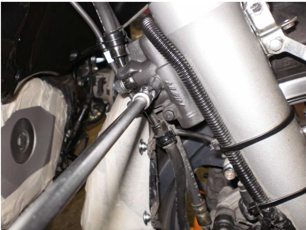
Demontáž zadního šroubu blatníku na levé straně.
