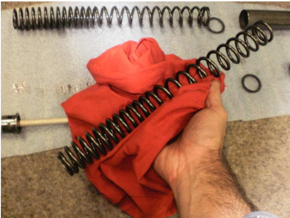
Všechny součástky, tlumič, pružiny, podložky, distanční trubky vzorně vyčistíme
