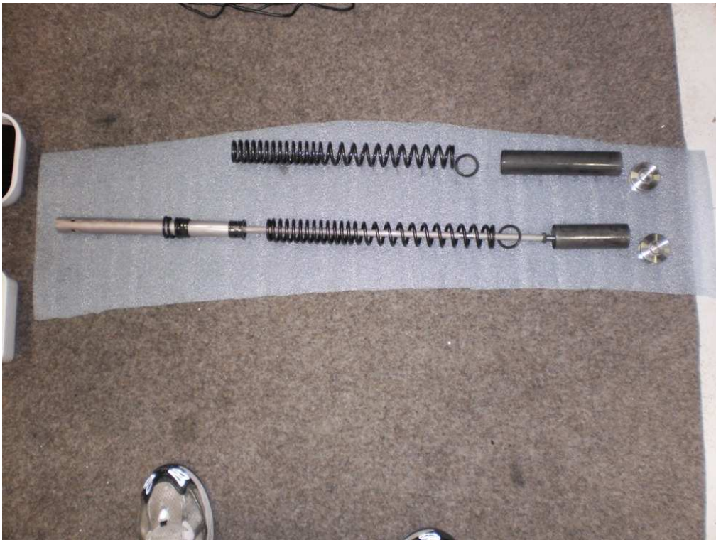
Vyjmuté komponenty z obou tlumičů / antidive v levém zůstává/
