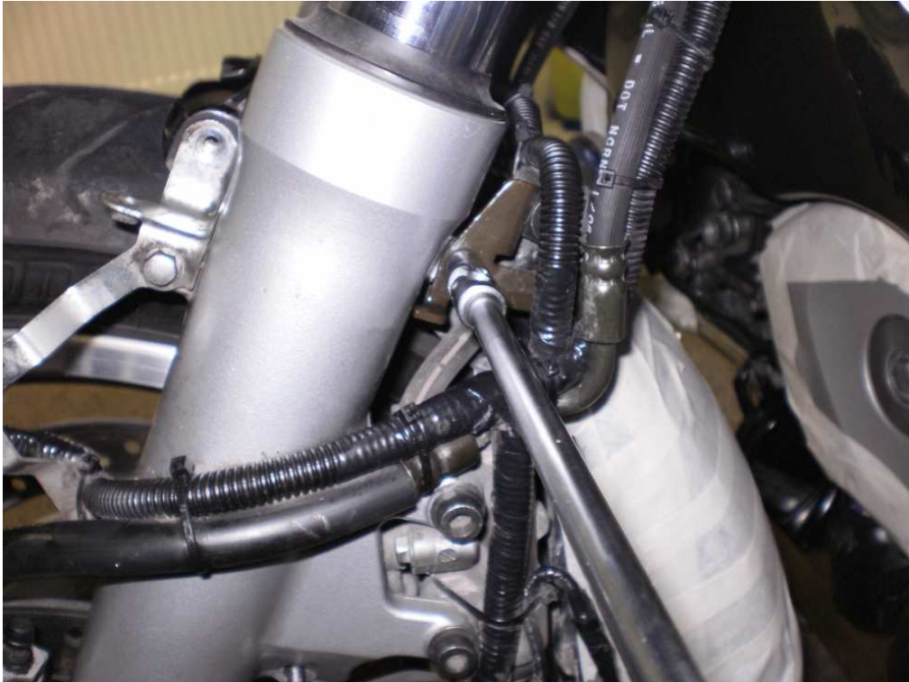
Demontáž levého zadního šroubu blatníku.
